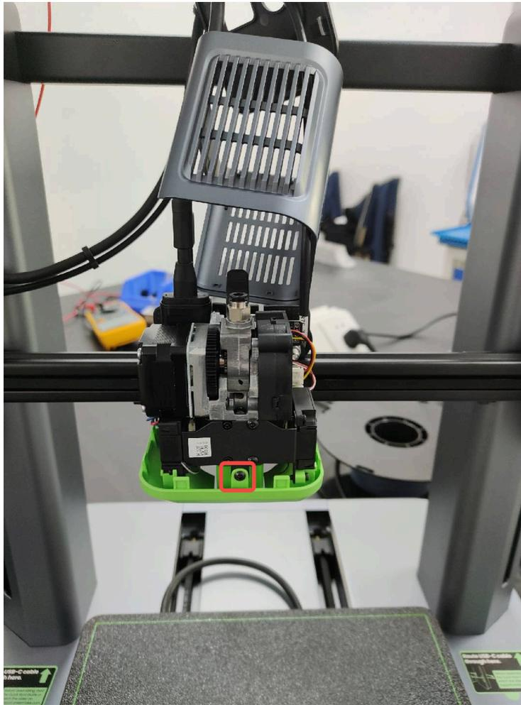
12) ノズルカバーと上部カバーを取り付け、H2.0の六角レンチを使ってエクストルーダー背面にある4箇所のネジを締めます。
