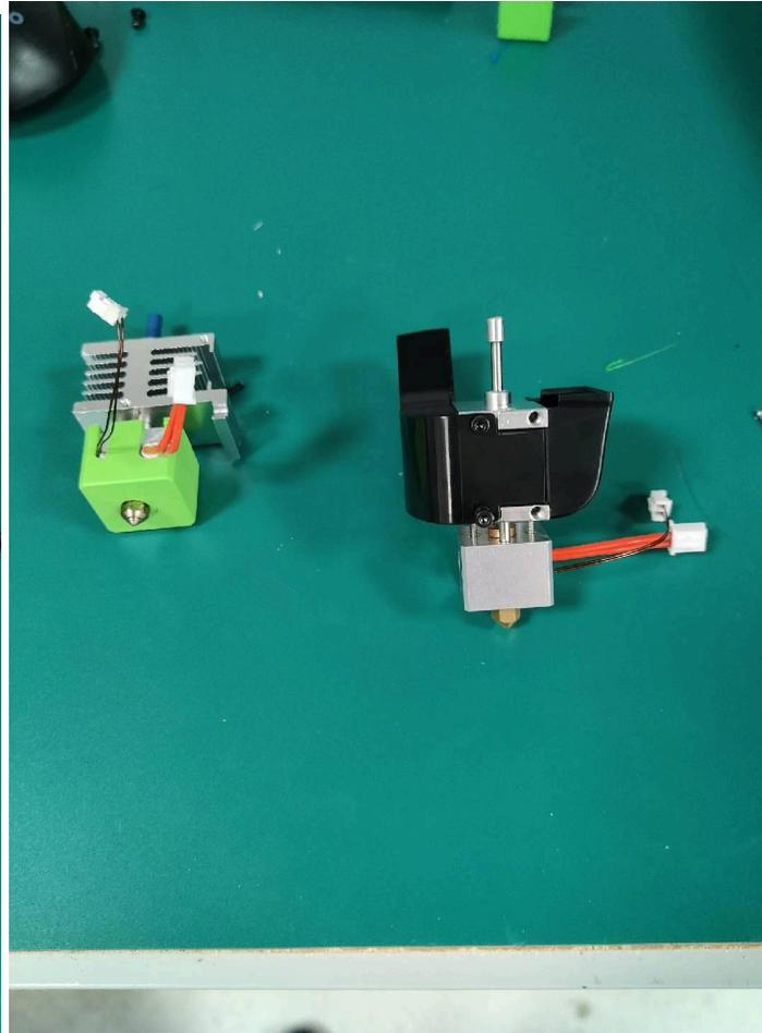
6) エクストルーダーをホットエンドに取り付け、H2.0の六角レンチでネジを締めます。
