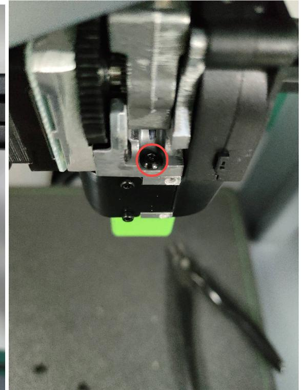
3) H2.0の六角レンチを使ってエクストルーダー背面の3箇所のネジを外し、エクストルーダーを解体します。
