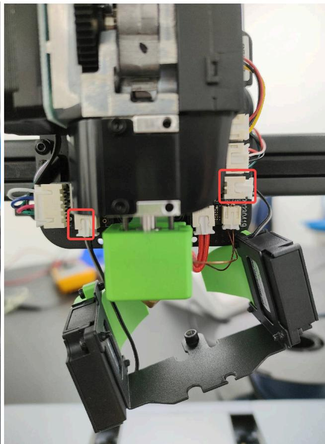
8. ホットエンドとシリコンカバー (以下写真の、緑の部分) の間に、以下の写真で示している絶縁チューブがあるか確認します。
