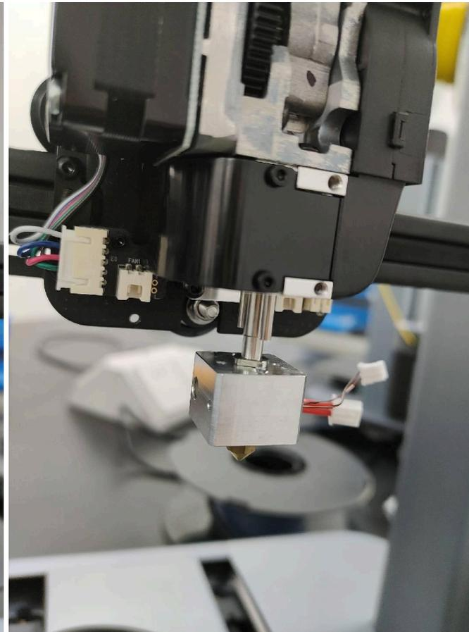
3) 交換用ホットエンドからシリコンカバーを取り外し、ホットエンドの2箇所のネジをH1.5の六角レンチで締めます。
