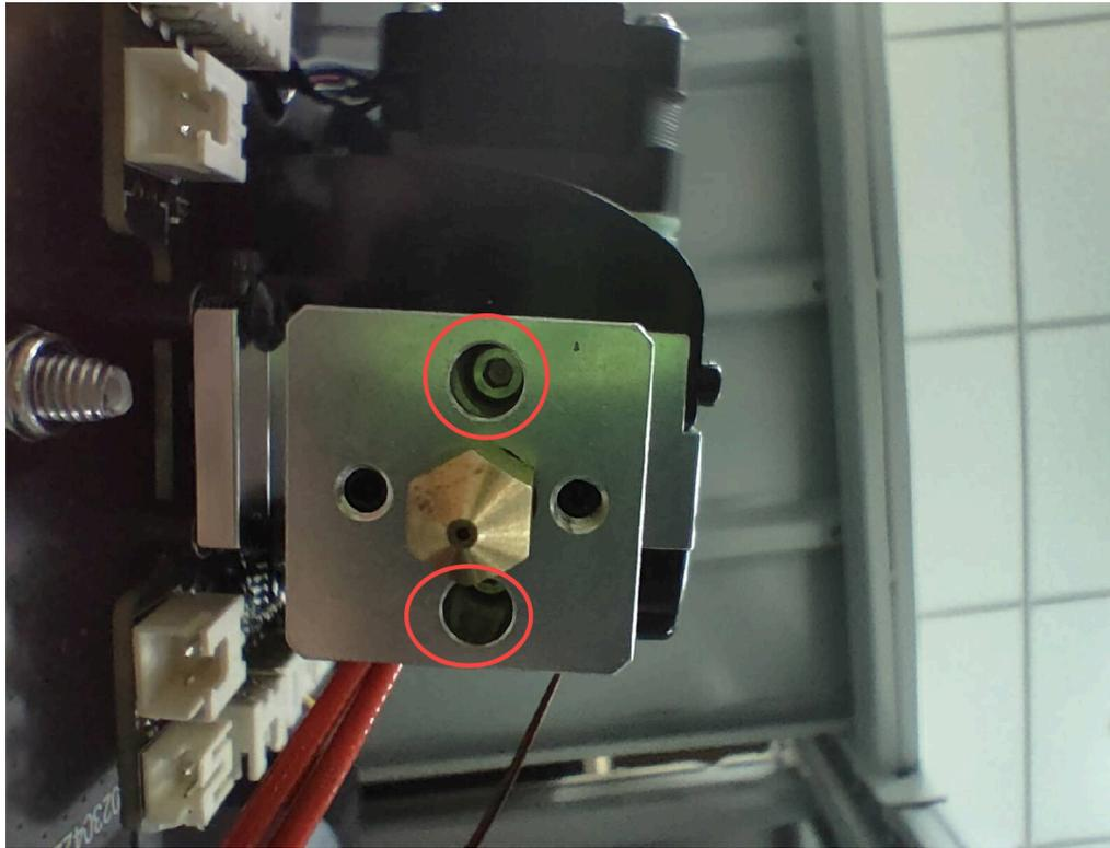
5) シリコンカバーを取り付け、以下の写真で示している2本のコード (ヒーターチューブとサーミスタ) を接続します。
