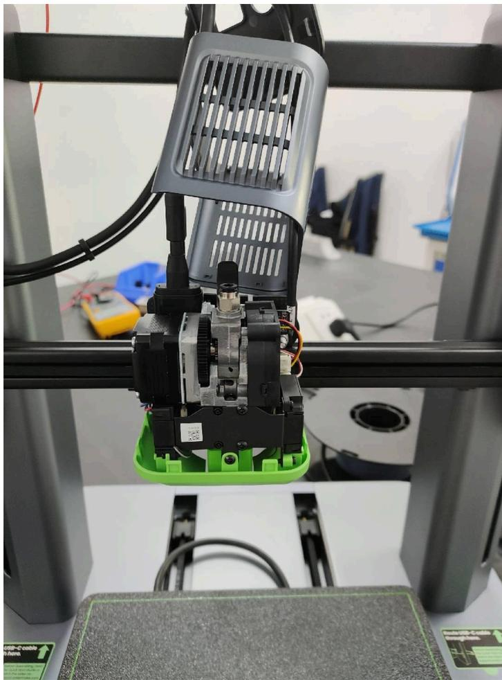
6. H2.0の六角レンチを使ってエクストルーダー底面にある4箇所のネジを外し、底面のカバーを取り外します。
