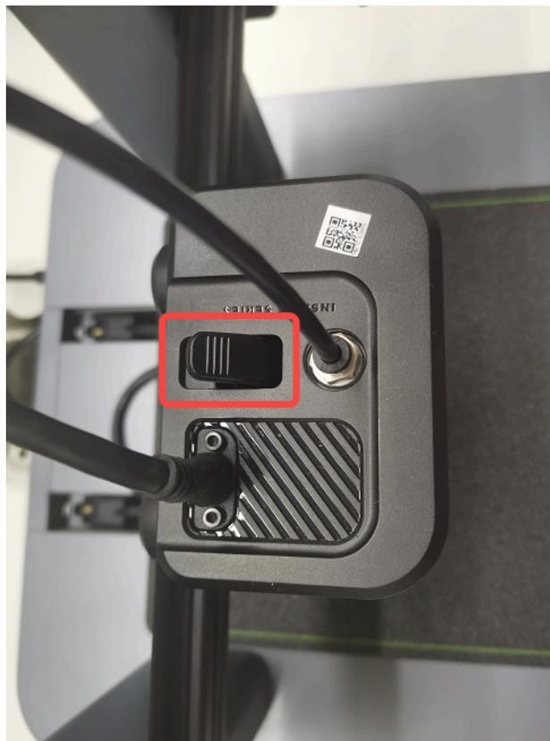
3. タッチパネルで、[コントロール] > [位置調整] の順にタップし、エクストルーダーのZ軸を200mm上に、X軸を(エクストルーダーが)プリンターの中央にくるように移動させます。その後プリンターの電源をオフにし、ホットエンドの温度が下がるまで待ちます。
