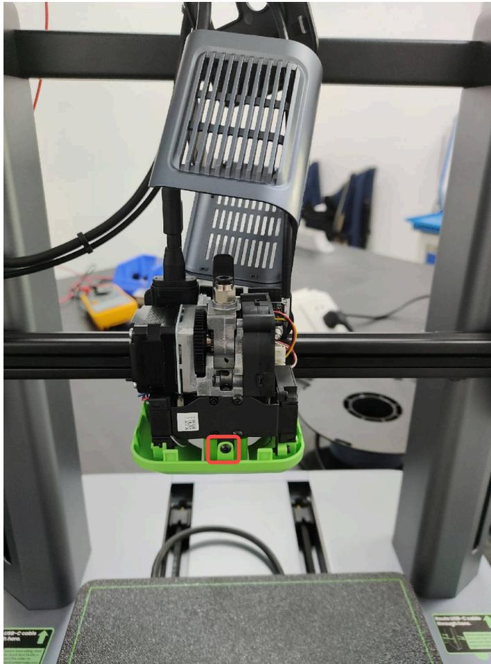
8) ノズルカバーと上部カバーを取り付け、H2.0の六角レンチを使ってエクストルーダー背面にある4箇所のネジを締めます。
