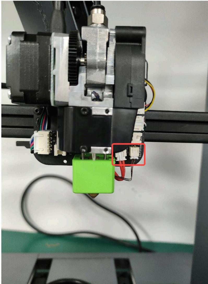
10) 以下の写真で示している2箇所のコードを接続します。その後、H2.0の六角レンチを使って、2枚目の写真で示している2箇所のネジを締めます。
