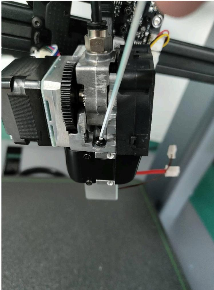
7) エクストルーダーを取り付けたら、以下の写真で示している3箇所のネジをしっかりと締めます。
