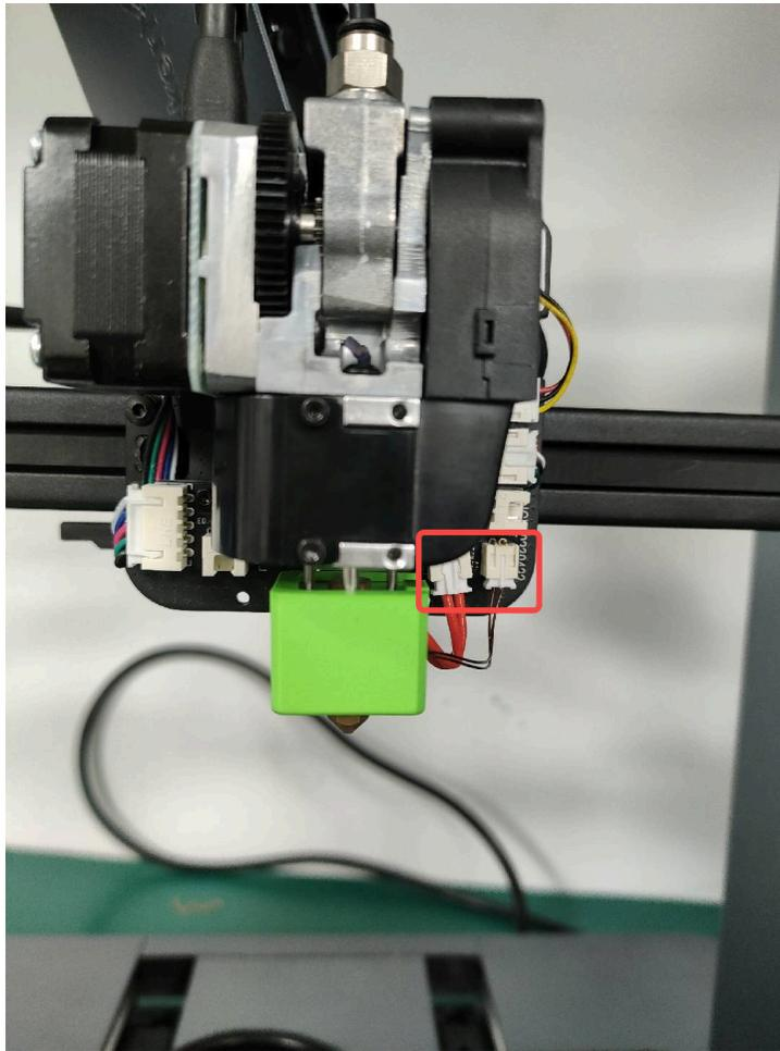
6) 以下の写真で示している2箇所のコードを接続します。その後、H2.0の六角レンチを使って、2枚目の写真で示している2箇所のネジを締めます。
