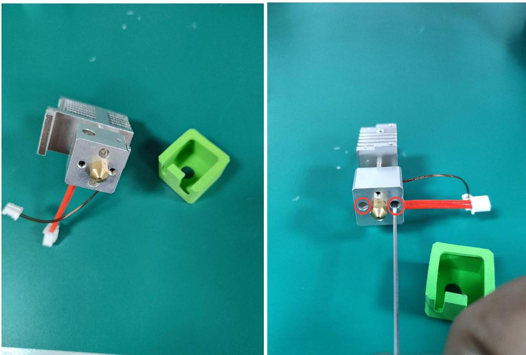
2) H2.0の六角レンチを使って、現在使用しているシリコンカバーとエクストルーダーのネジを取り外します。
