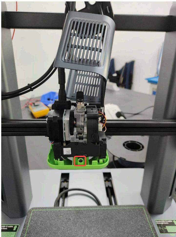
7. H2.0の六角レンチを使ってフロント冷却ファン部の2本のネジを外し、左右の冷却ファンワイヤーを引き抜いて冷却ファン部を取り外します。
