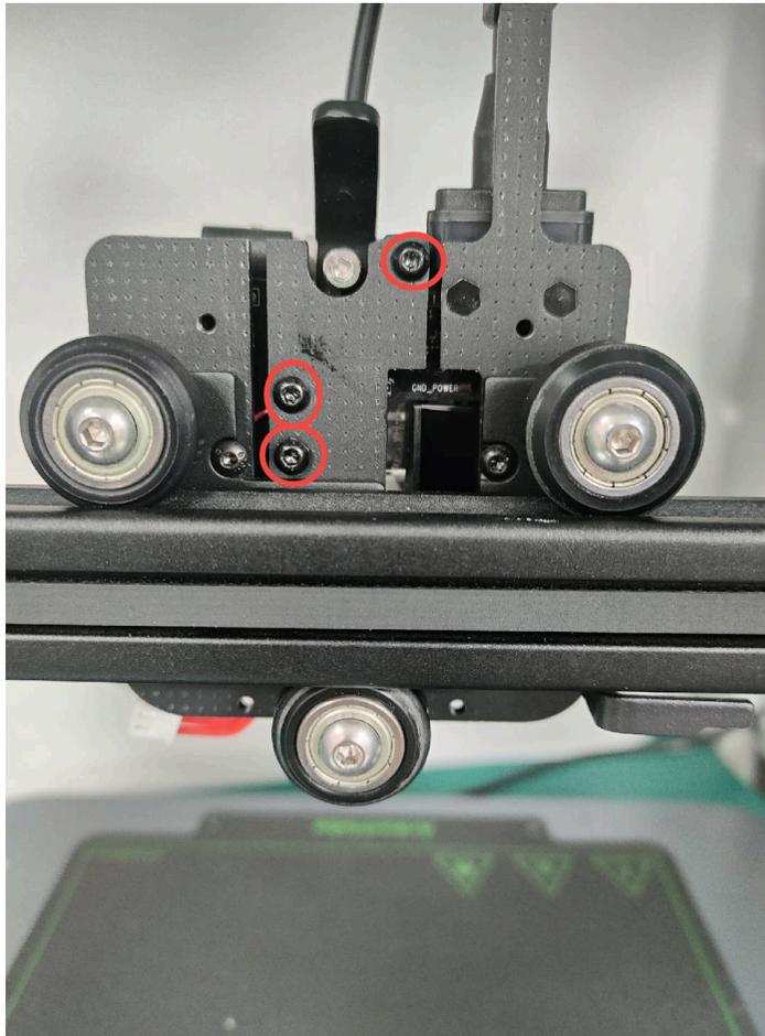
8) H2.0の六角レンチを使って、シリコンカバーの2箇所をM3のネジで締めます。
