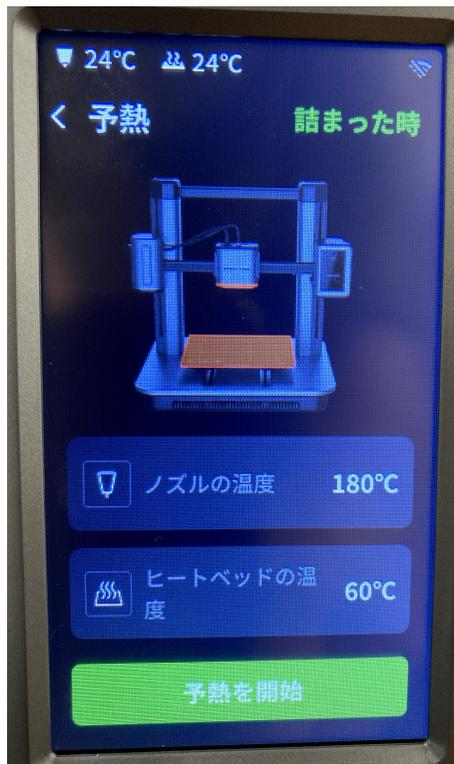
2. タッチパネルで、[コントロール] > [押し出し] > [アンロード] の順にタップし、フィラメントを取り出します。フィラメントを取り出す際に内部で抵抗を感じたら、エクストルーダーの上部にある「押し出しボタン」を押しながら引き出してください。
