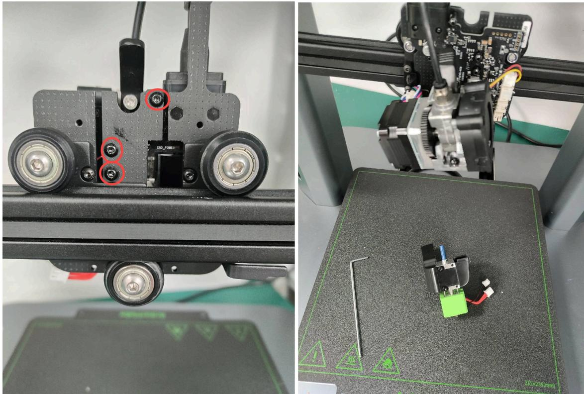
4) 下の写真で示している5箇所のネジを、H1.5の六角レンチを使って外します。
