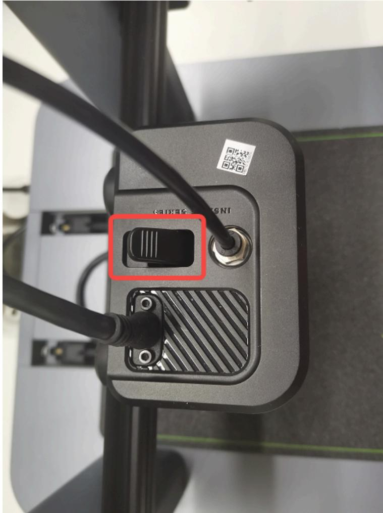
14) プリンターの電源をオンにし、タッチパネルで [コントロール] > [押し出し] > [ロード] の順にタップします。ノズルが所定の温度まで加熱されたら、フィラメントがノズルから問題なく押し出されているか確認します。
