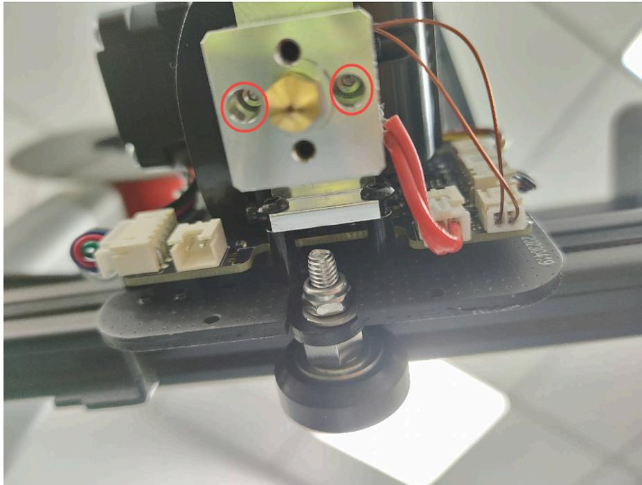
2) プリンターの電源をオフにし、ホットエンドの温度が下がるまで待ちます。その後、下の写真で示している2箇所のコードを外し、ホットエンド (シリコンカバーを除く) を取り外します。
