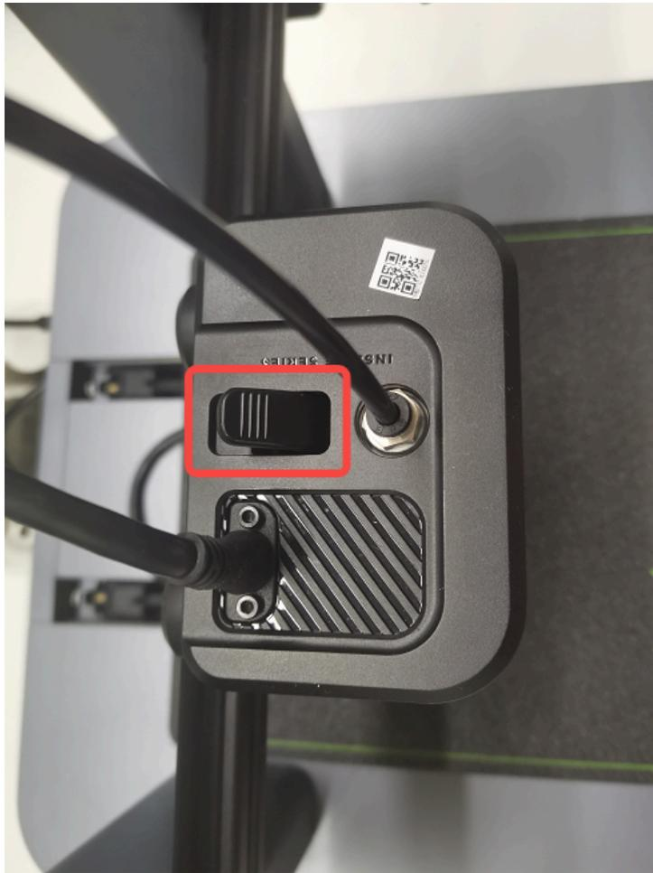
10) プリンターの電源をオンにし、タッチパネルで [コントロール] > [押し出し] > [ロード] の順にタップします。ノズルが所定の温度まで加熱されたら、フィラメントがノズルから問題なく押し出されているか確認します。
