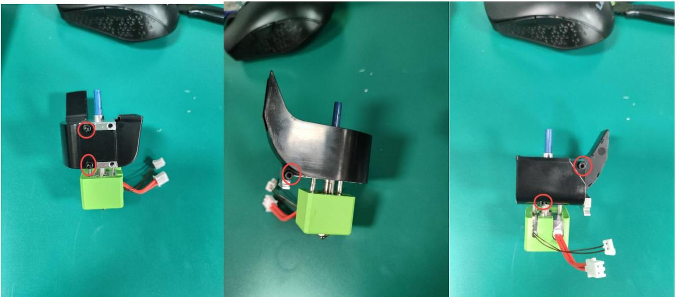
5) 取り外したエアガイド (以下の写真上部にある黒い部品) を交換用ホットエンドに取り付け、H1.8 の六角レンチを使ってネジを 5 箇所締めます。
