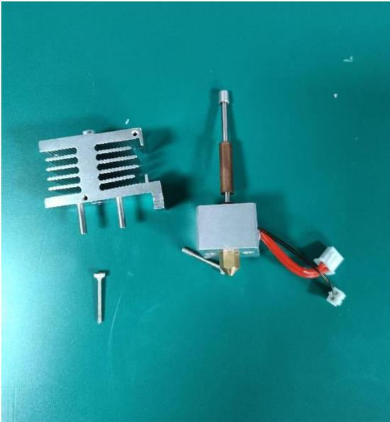
4) 交換用ホットエンドをシリコンカバーに垂直に挿入し、H1.5の六角レンチを使ってネジを2箇所締めます。ホットエンドを取り付ける際は、ヒーターチューブとサーミスタがプリンターの右側にくるように、向きにご注意ください。
