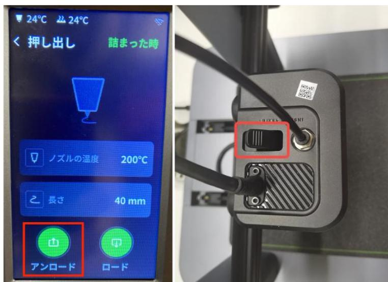
3. タッチパネルで、[コントロール]>[位置調整] の順にタップし、エクストルーダーのZ軸を200mm上に、X軸を（エクストルーダーが）プリンターの中央にくるように移動させます。その後プリンターの電源をオフにし、ホットエンドの温度が下がるまで待ちます。
