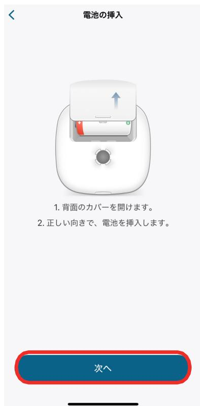
バッテリーの取り付け方を確認し、同梱電池をバッテリースロットに挿入します。
