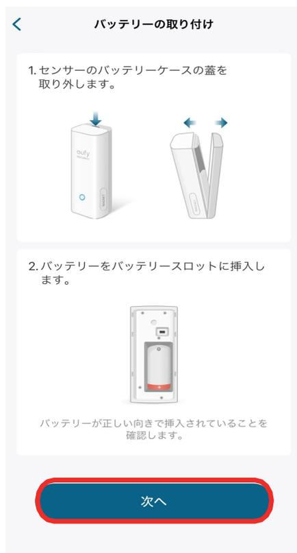
バッテリーの取り付け方を確認し、同梱電池をバッテリースロットに挿入します。
