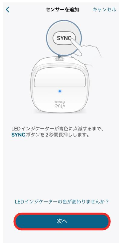
画面の指示に従って、製品本体にある [SYNC] ボタンを2秒間長押しし、ピープ音が鳴ったら「次へ」をタップします。
