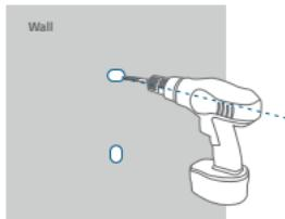
3. Lijn de gaten op de montageplaat uit met de gaten in de wand. Zorg ervoor dat de montageplaat in de juiste richting wordt geplaatst volgens de markeringen op de plaat. Steek de pluggen in de gaten; de pluggen zijn nodig voor harde muren van beton, baksteen, stucwerk, e.d. Gebruik een kruiskopschroevendraaier om de schroeven vast te draaien en de montageplaat aan de wand te bevestigen.
