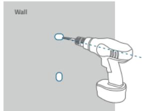
3. 取り付けプレートの穴を壁の穴に合わせて、UPとDOWNの方向に合わせてください。アンカープラグを穴に挿入してください。アンカープラグは、コンクリート、レンガ、漆喰などの硬い材料で作られた壁に必要です。プラスドライバーでネジを固定して、取り付けプレートを壁に取り付けてください。
