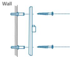
4. Alignez la fente de montage de la caméra intérieure avec la plaque, puis poussez la caméra vers le bas jusqu'à entendre un clic.
