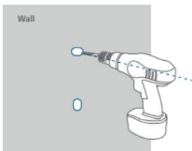
3. Alinee los orificios de la placa de montaje con los orificios taladrados en la pared, de modo que la orientación coincida con las marcas UP (arriba) y DOWN (abajo). Inserte los tacos dentro de los orificios; es necesario utilizar los tacos en paredes que están hechas con materiales duros, como hormigón, ladrillo o estuco. Apriete los tornillos con un destornillador Phillips para fijar la placa de montaje a la pared.
