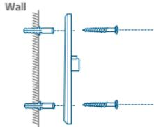
4. 本体の取り付けスロットを取り付けプレートに合わせ、カチッと所定の位置に収まるまでカメラを押し下げてください。
