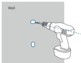
3. Richten Sie die Bohrungen in der Montageplatte mit den Löchern in der Wand aus. Achten Sie dabei auf die Richtungsangaben UP und Down. Setzen Sie die Dübel in die Löcher ein. Dübel sind für Wände erforderlich, die aus einem harten Material wie Beton, Ziegel oder Gips bestehen. Ziehen Sie die Schrauben mit einem Kreuzschlitzschraubendreher an, um die Montageplatte an der Wand zu befestigen.
