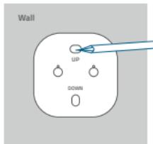
2. Bohren Sie die Löcher mit einem 6-mm-Bohrer.
