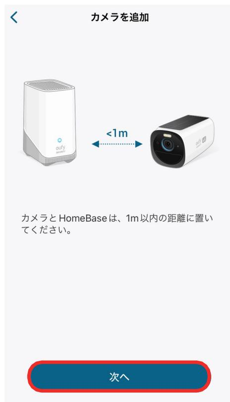
カメラとHomeBase S380を1m以内の距離に置き、「次へ」をタップします。
