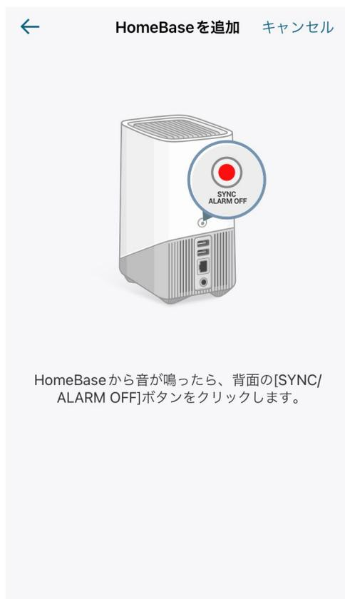
HomeBase S380から音が鳴ったら、背面の [SYNC / ALARM OFF] ボタンを押します。
