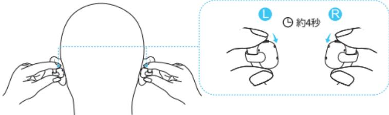
※充電ケースを使わずに電源をオンにする場合、通知音が聞こえるまで両方のイヤークリップのボタンを約4秒間長押しします。
