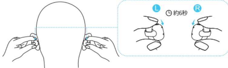
※充電ケースを使わずに電源をオフにする場合、両方のイヤークリップのボタンを約6秒間長押しします。
