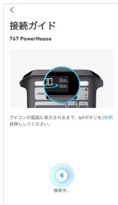
ポータブル電源の「IoT」ボタンを、ロゴが点滅するまで2秒間長押しします。
