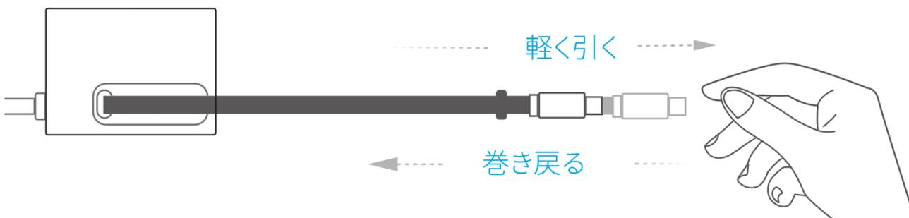
注: ケーブルを短く調整したい場合は、ケーブルを軽く引いて巻き戻した後、希望の長さまで引き出します。
