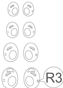
3. イヤーウィングの楕円形の穴をイヤホンの装着検出センサーに合わせます。
