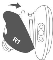
5. イヤホンの先端を持って、イヤーウィングを所定の位置まで伸ばします。イヤーウィングが曲がっていないことを確認します。
