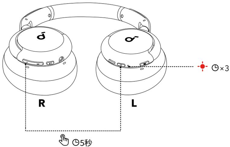
片耳からしか音が聞こえない場合や本製品と機器を適切に接続できない場合は、以下の手順で本製品のリセットを行ってください。本製品の電源をオンにして状態で、電源ボタンと音量ボタン (+) を同時に 5 秒間長押しして、LED インジケータが赤色に 3 回点滅するまで待ちます。
