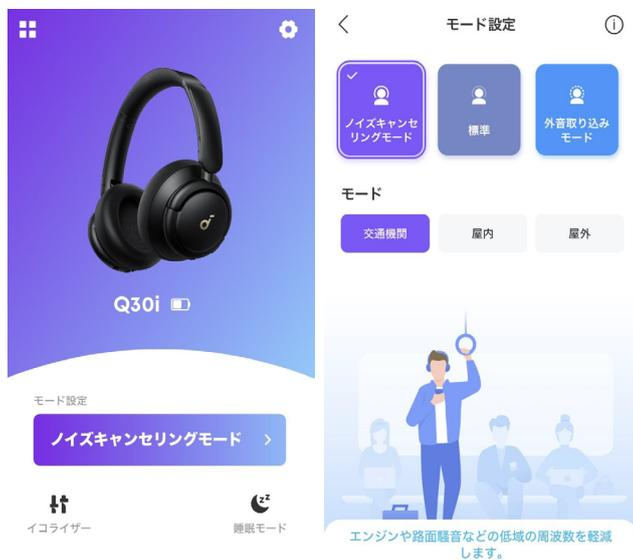
ヘッドホンのNCボタンを押してノイズキャンセリングモードをオンにすると、周囲のノイズを軽減します。Soundcoreアプリで、お好みの設定を選択します。
