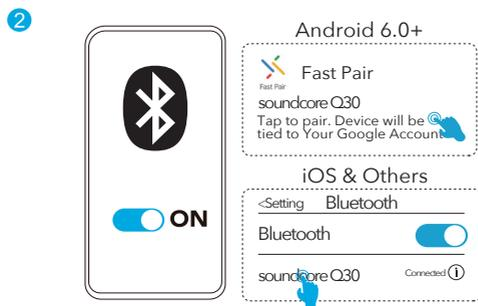
**自動ペアリング**：電源ボタンを3秒間長押しすると、電源がオンになります。本製品は初めてご利用になる際は自動的に Bluetooth ペアリングモードに入ります。ご使用の機器の Bluetooth リストで「soundcore Q30」を選択し、接続します。
