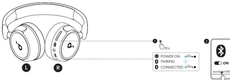
多機能ボタンを3秒間長押しすると、電源がオンになります。本製品は初めてご利用になる際は自動的に Bluetooth ペアリングモードに入ります。ご使用の機器の Bluetooth 設定画面で「**soundcore H30i**」を選択し、接続してください。ペアリング中、ヘッドフォンの LED インジケータは青色ですばやく点滅します。ペアリング完了すると、LED インジケータは3秒間点灯し、その後消灯します。
