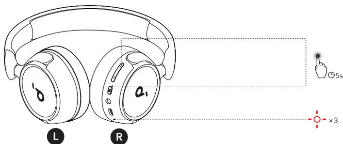
片耳からしか音が聞こえない場合や機器を適切に接続できない場合は、リセットを行ってください。まず、Bluetooth 機器から本製品とのペアリングの履歴を削除します。LED インジケーターが赤色に3回点滅するまで、音量アップボタンと多機能ボタンを同時に5秒間長押ししてください。
