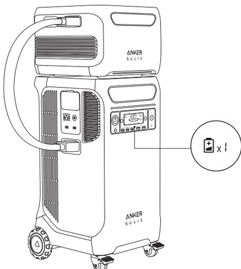
6. ショートを防ぐために、本製品と Anker SOLIX F3800 Portable Power Station を使用中に接続を切断または再開する必要がある場合は、本製品の電源ボタンを 2 秒間長押しして下さい。ケーブルを外すときは黒い部分を押しながら外して下さい。
