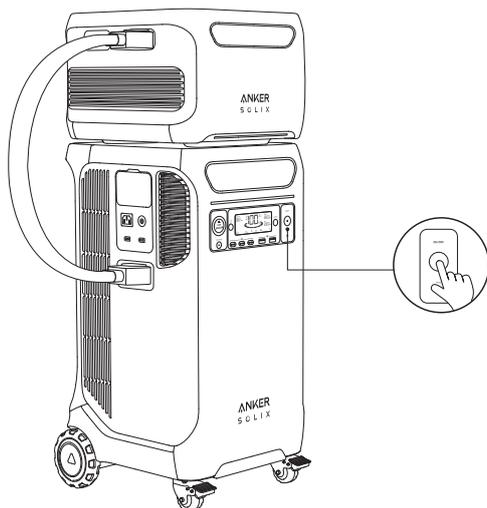
4. 付属のバッテリー接続ケーブルを使用して本製品を Anker SOLIX F3800 Portable Power Station と接続します。このケーブルは他の拡張バッテリーと接続する時にも使用できます。最大 6 個の拡張バッテリーを Power Station に接続できます。
