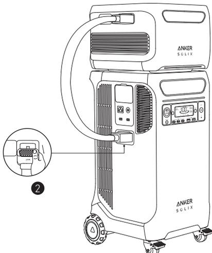
3. Anker SOLIX F3800 Portable Power Station の電源をオフにしてから、本製品と接続します。
