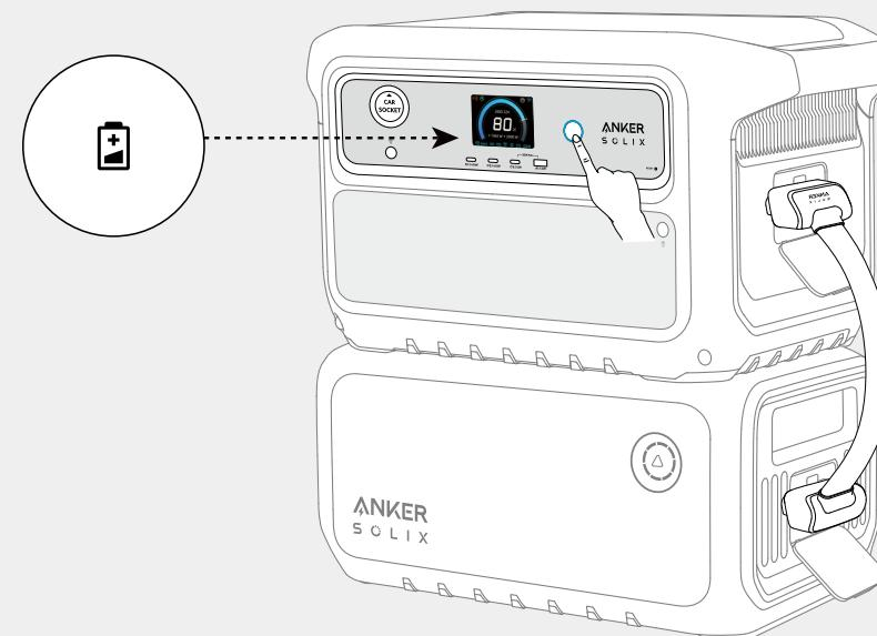
使用中に本製品をポータブル電源から外す際は、本製品の電源ボタンを3秒間長押しして、電源オフにしてから、接続ケーブルを外します。
