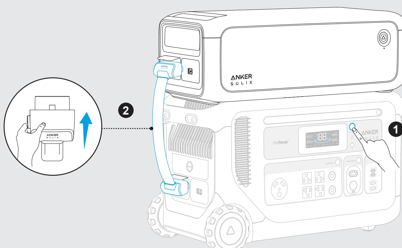
2. コンセントもしくはシガーソケット / ソーラーパネルから充電します。拡張バッテリーも同時に充電されます。
