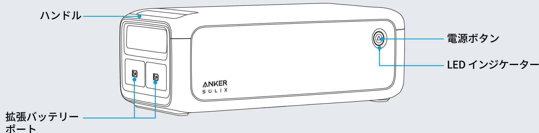
**電源ボタン**：3秒間長押しして電源のオン / オフを切り替えます。
