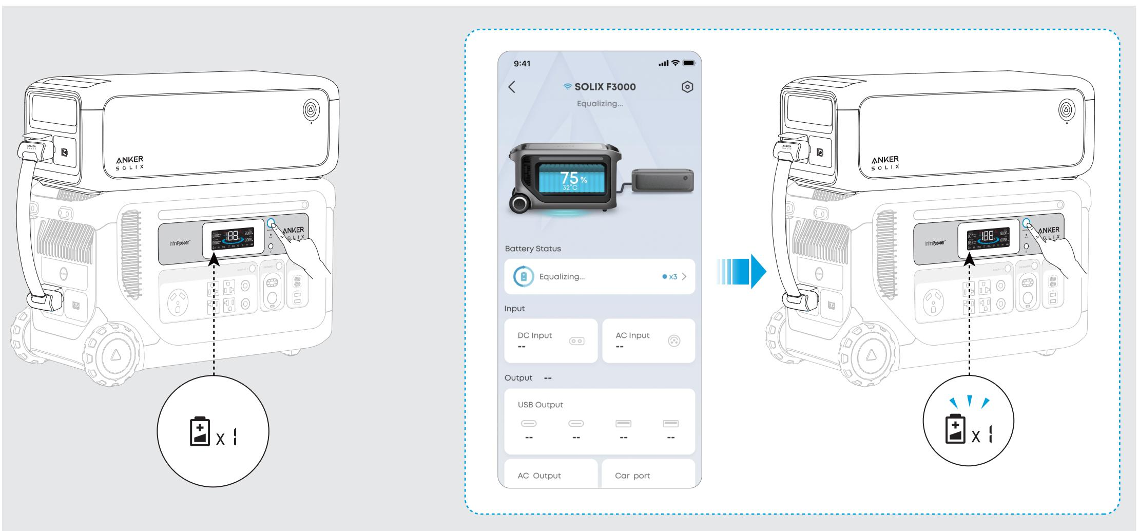
4. ショートを防ぐために、本製品と Anker Solix F3000 Portable Power Station を使用中に接続を切断する必要がある場合は、本製品の電源ボタンを 3 秒間長押しして下さい。次に、ケーブルを外してください。
