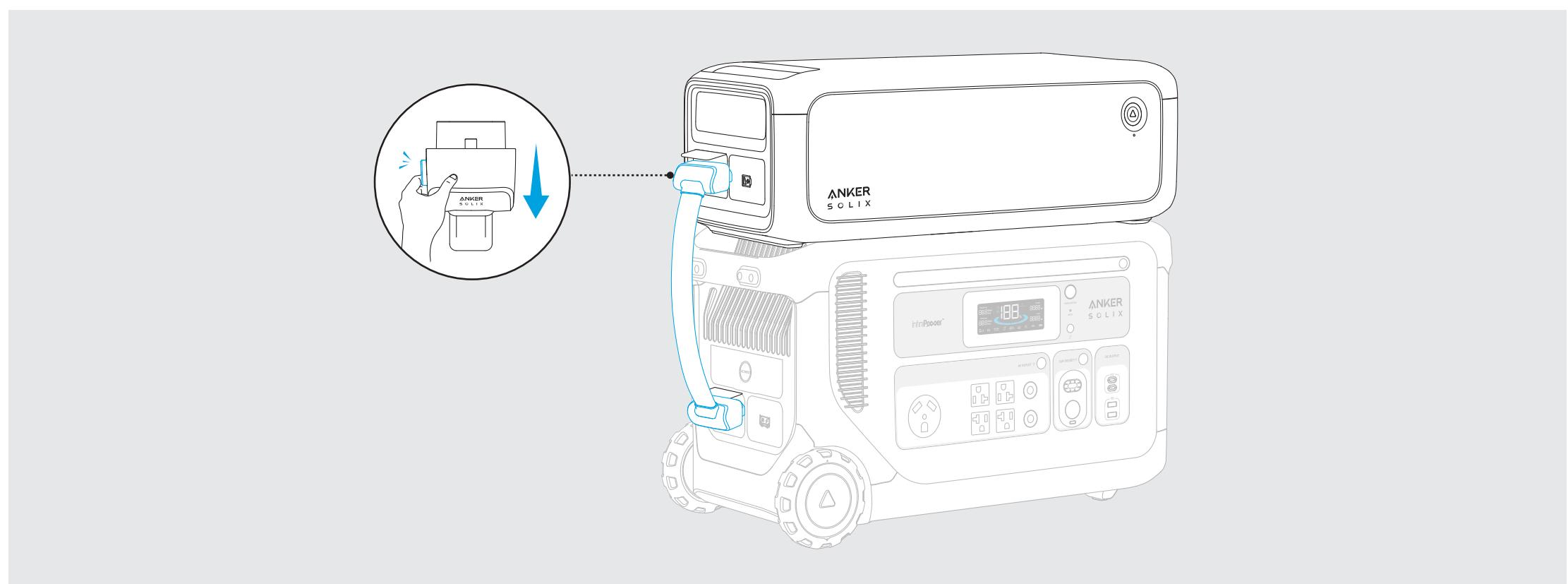
2. 最大3個の拡張バッテリーをAnker Solix F3000 Portable Power Stationに接続できます。複数の拡張バッテリーを接続している場合、アプリ内の電球ボタンをタップすると、対応する拡張バッテリーのLEDが3回点滅します。
