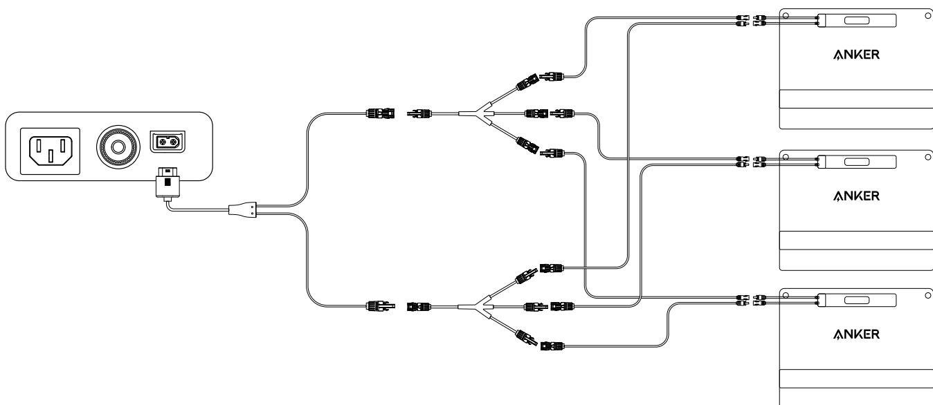
Anker SOLIX ソーラーパネル製品にソーラー充電ケーブルおよび延長ケーブルが同梱されています。複数のソーラーパネルを並列接続する場合は、Anker 公式サイトからソーラー充電コネクタをご購入ください。
