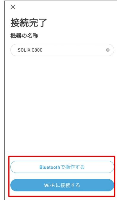
接続が完了したらデバイスに任意の名前をつけ、「Bluetoothで操作する」または「Wi-Fiに接続する」をタップします。
