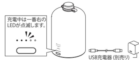
パススルー充電を行う(本製品を充電しながら同時に他の電子機器への給電を行う)場合
