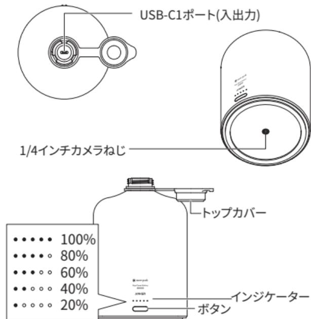
インジケータはバッテリーの残量によって点灯する数が変わります。
