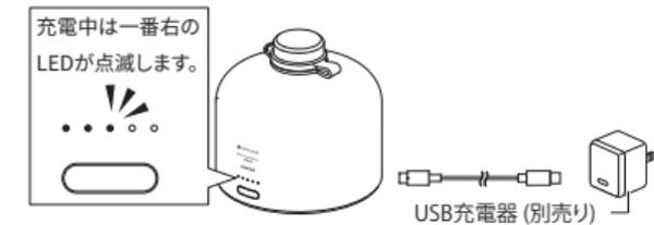
パススルー充電を行う(本製品を充電しながら同時に他の電子機器への給電を行う)場合
